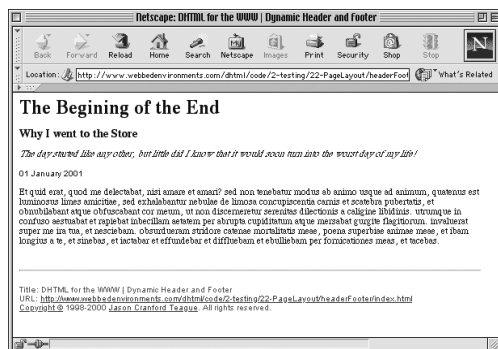
Rysunek 22.12. Końcowy wygląd strony z dynamicznie stworzoną stopką i nagłówkiem. Ponieważ kodu nagłówka i stopki nie umieszczamy na stronie, możemy zmienić jej układ w plikach JavaScript, a zmiany zostaną naniesione na każdej używającej ich stronie HTML
