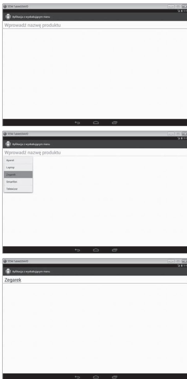
Rysunek 4.7. Kontrolka EditText z prośbą o podanie nazwy produktu (górny obrazek). Pokazujący dostępne opcje widżet PopupMenu, który został wyświetlony po kliknięciu kontrolki EditText (środkowy obrazek). Produkt wybrany z PopupMenu pojawia się w kontrolce EditText (dolny obrazek)
