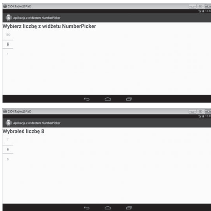
Rysunek 4.2. Widżet NumberPicker wyświetlający liczby od ustalonej wartości minimalnej (górny obrazek) oraz wybrana liczba wyświetlona za pomocą kontrolki TextView (dolny obrazek)
